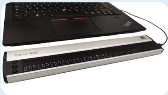
Laptop mit angeschlossener Braillezeile [7]
