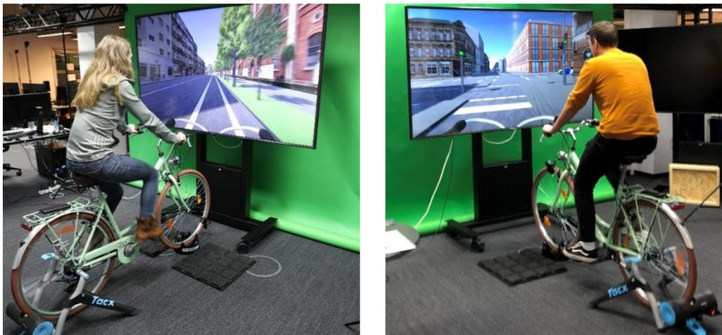
Abbildung 9: Verändertes Setup ohne VR-Brille nach Pretests
