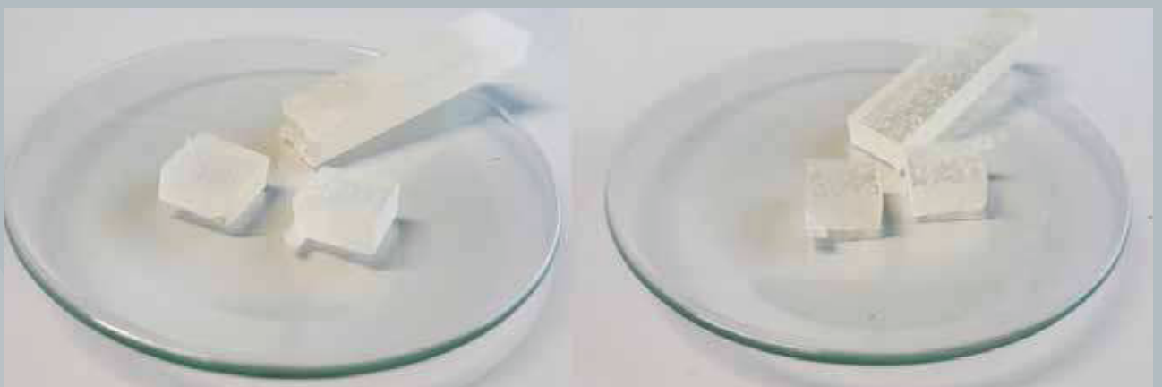
Abbildung 8: Probekörper der Epoxidharze mit Maßen von ca. 10 x 10 x 6 mm gehärtet mit Isophorondiamin (links) und 2-Methyl-1,5-diaminopentan (rechts).
