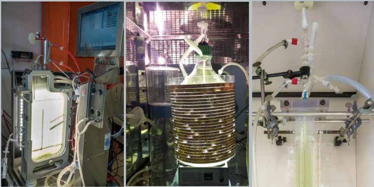
Abbildung 1: Plattenreaktor, Labfors 5 Lux mit LED flat panel (Infors HT) (l.), Schottflasche Reaktor, KIT System (m.) und Bag-Reaktor (r.).
