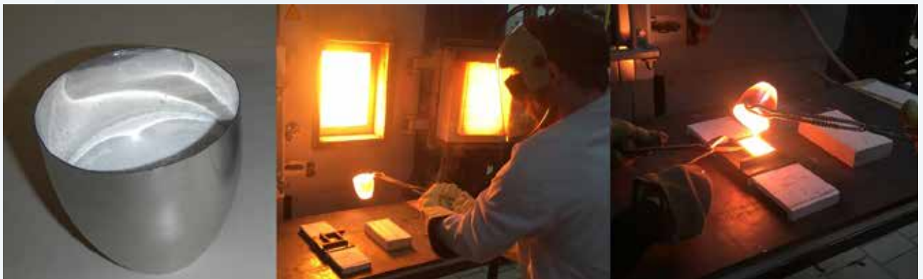
Bild 1: a) Rohstoffgemenge im Platin-Gold-Tiegel, b) Ausgießen der Schmelze, c) Abschneiden der Glasschmelze.
