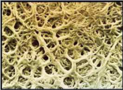
Abbildung 1: Die REM-Aufnahme (5000-fache Vergrößerung) eines Lithium-Komplexfettes zeigt ein „Geflecht“ aus Lithiumhydroxystearat; das eigentliche Schmieröl befindet sich dazwischen (J.E. Martin-Alfonso, et. al.; Development of new lubricating grease formulations using recycled LDPE as rheology modifier additive, European Polymer Journal; 43; 2006).
