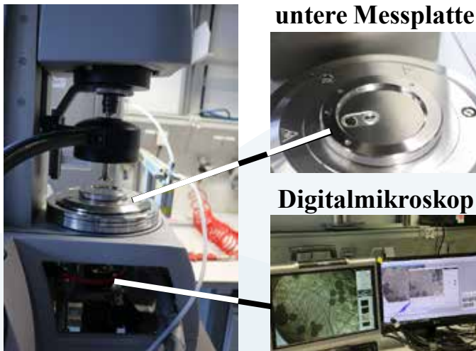
Abbildung 5: Unterhalb des Rheometers wird das Mikroskop schwingungsentkoppelt angeflanscht (links). Durch zwei kreisförmige Öffnungen in der unteren Messplatte ist die Probe optisch zugänglich. Die Bilder bzw. Videos des Digitalmikroskops lassen sich während einer rheologischen Messung direkt mitverfolgen.
