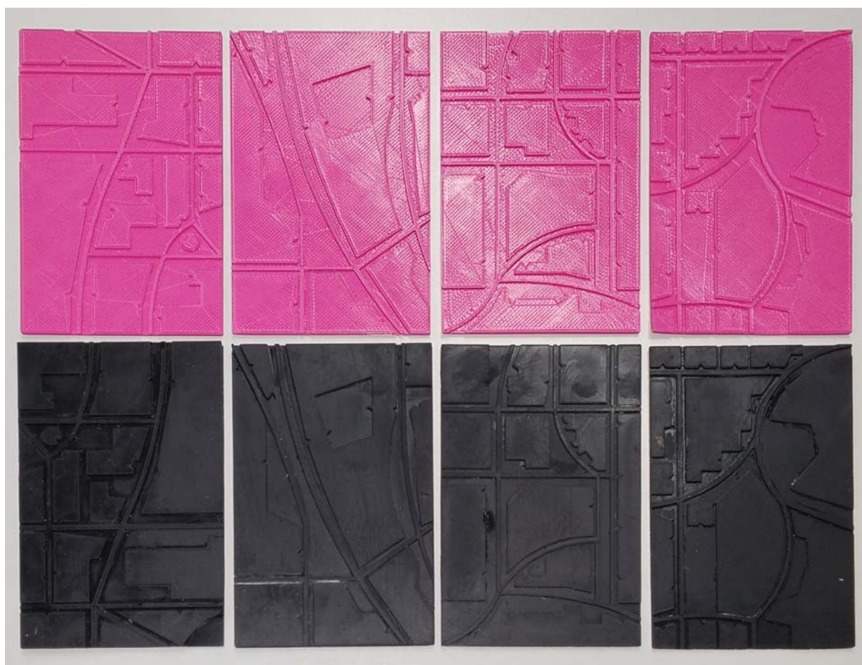
Abbildung 3: Karten zu Testfall 1 (oben: Schmelzschichtungsverfahren, unten: Stereolithographieverfahren). Die beiden Karten auf der linken Seite dienten dabei als zur Erklärung der jeweiligen Aufgaben für die an der Studie Teilnehmenden.
