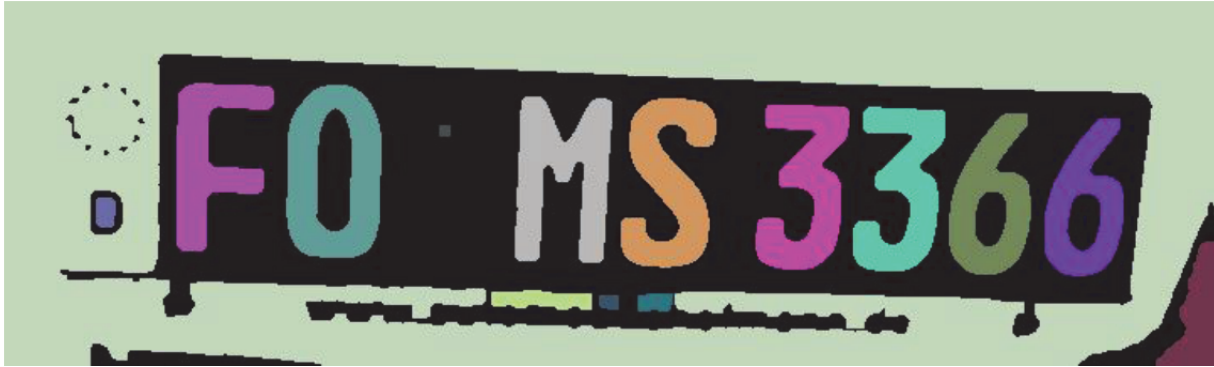
Abbildung 4: Zusammenhangskomponenten des Bildes.
