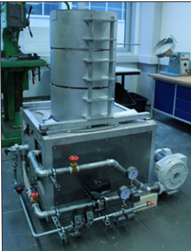
Abb.2: Wirbelschichtreaktor mit Gasregelstrecke und Luftgebläse
