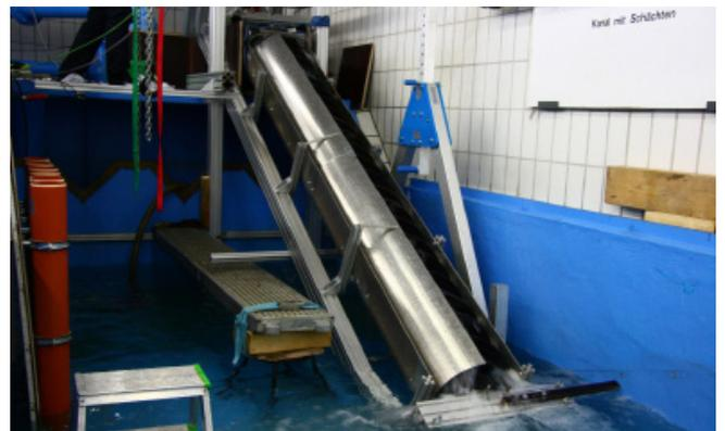
Abb.1: Versuchsaufbau der Wasserkraftschnecke mit Getriebe und Generator im Labor „hydro.ohm“
