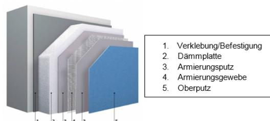
Abb.1: Aufbau eines Wärmedämmverbundsystems
