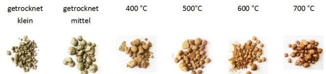
Abb. 1: Das Sintern der Granulate bei unterschiedlichen Temperaturen
