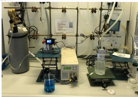
von links nach rechts: CO<sub>2</sub>-Druckgasflasche, Durchflussregler, HPLC-Pumpe, Becherglas mit Reaktionslösung vor Reaktor, dahinter LTF-Mikromischer, vorne blaue Produktlösung nach Reaktor
