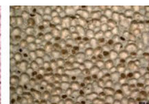
Abbildung mitte bis rechts: Wärmedämmende Geopolymer-Schäume mit einer Druckfestigkeit von 2 MPa und einer Wärmeleitfähigkeit von \lambda_{10} , t_r = 0,065 W/(mK)
