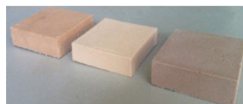
Abbildung links: Hochfeste Geopolymer-Steine mit Druckfestigkeiten zwischen 70 bis 120 MPa
