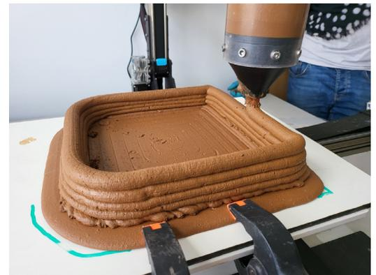
Abbildung: 3-D-Druck eines Demonstrators mit Abmaßen 450x450x500 mm aus 100% Recycling-Bauschutt.
