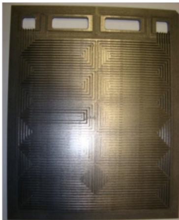
Abb.1: Bipolarplatte aus ternären Material-Compound
