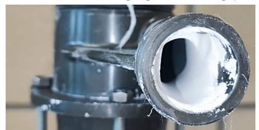
Abb.2: Ablagerungen am Einlass eines Laborzyklons
