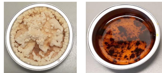
Abb.: Epoxidharze nach teilweiser und vollständiger Zersetzung.
