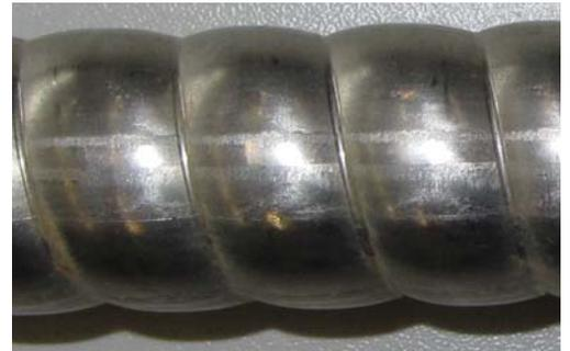
Abb.:1 Strukturrohr aus Edelstahl.
