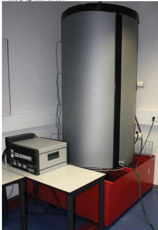
Abb.:2 Versuchsspeicher mit zwei Heizstäben und einem Betriebsführungssystem
