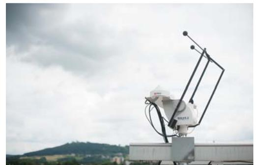
Abb.:1 Pyrhanometer mit Solartracker zur Erfassung der Global-, Direkt- und Diffusstrahlung am Forschungs- und Entwicklungszentrum in Neumarkt.
