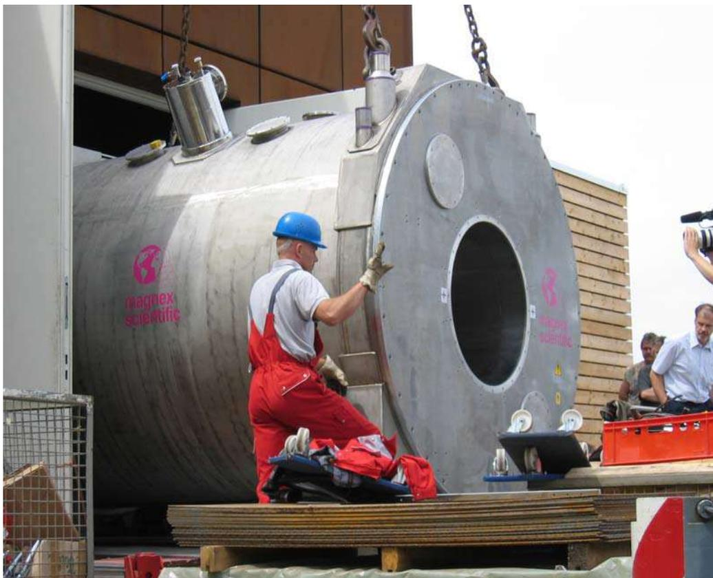
**Bild 1:** MRT mit Supraleiter-Spule [1]
