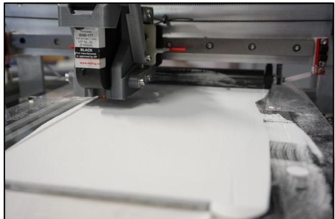
Im Rahmen dieser Arbeit sollen alle Düsen des Druckkopfes angesteuert werden. Dazu ist eine passende Platine zu entwickeln.
