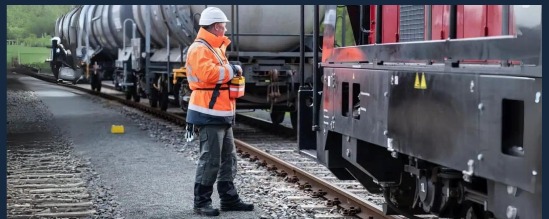
Triebfahrzeugführer mit konventioneller Funkfernsteuerung Bildquelle: https://www.cattron.com/de/markets-applications/rail-control/
