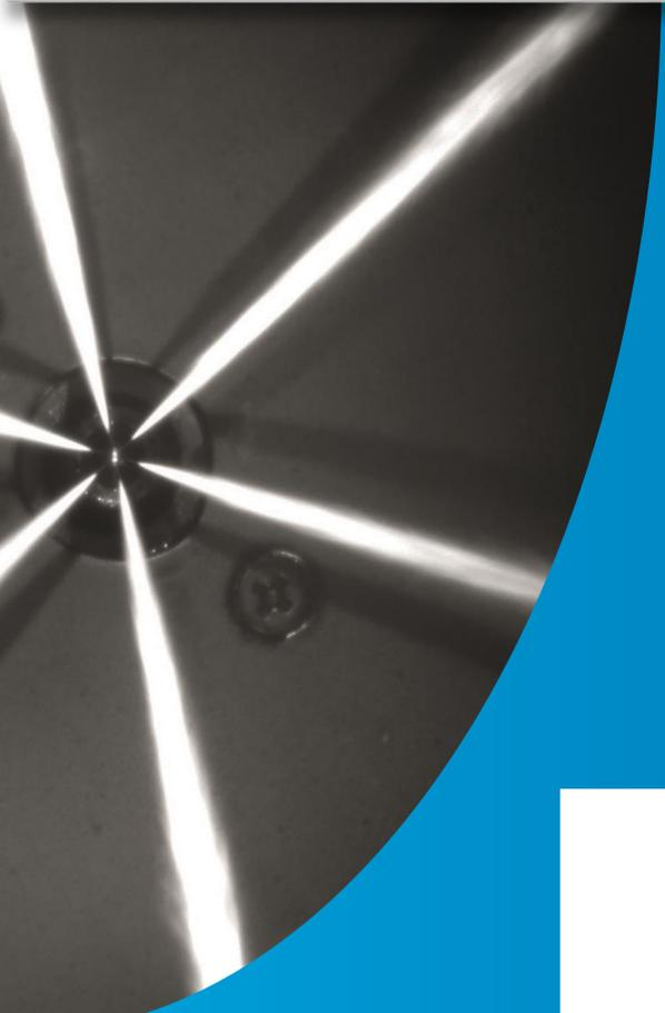
Sprayachse aus Symmetrie-Analyse und Intensitätsverlauf
