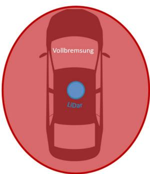
Auto führt eine **Vollbremsung** aus, wenn der **LiDAR** ein Objekt im Bereich von 1,5 m um das Fahrzeug herum wahrnimmt
