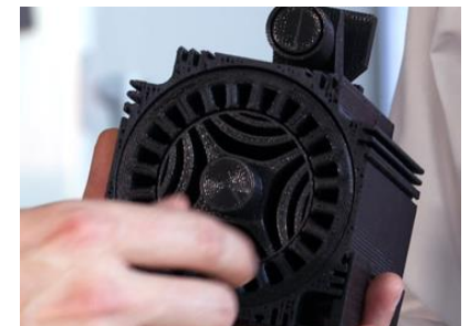
Abb. 2: 3D-gedrucktes Modell einer Reluktanzmaschine
