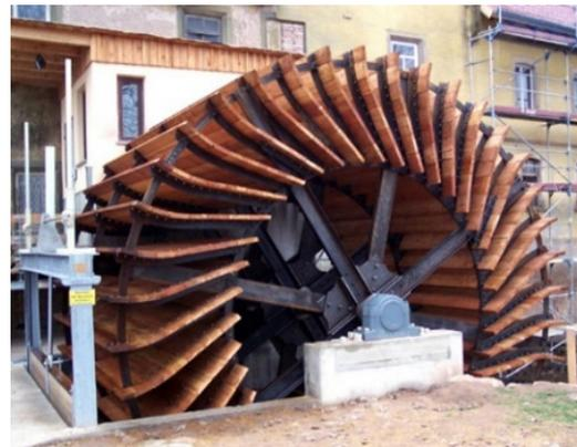
Abbildung 4: Kleinwasserkraftwerk mit Wasserrad
