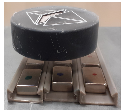
Abb. 2: Schwebender YBCO-Supraleiter (Fa. Quantum Levitation)
