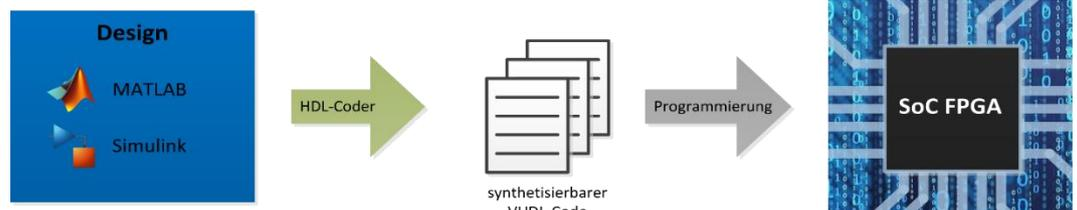
Abb.3: Automatisierter Workflow für Rapid Control Prototyping am Institut ELSYS
