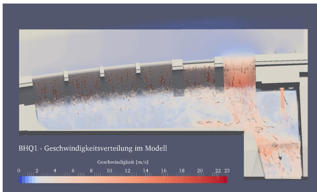
Abbildung 3: Verteilung und vektorielle Darstellung der Fließgeschwindigkeiten im Modell bei BHQ1, rechte FBK und linker Grundablass geöffnet
