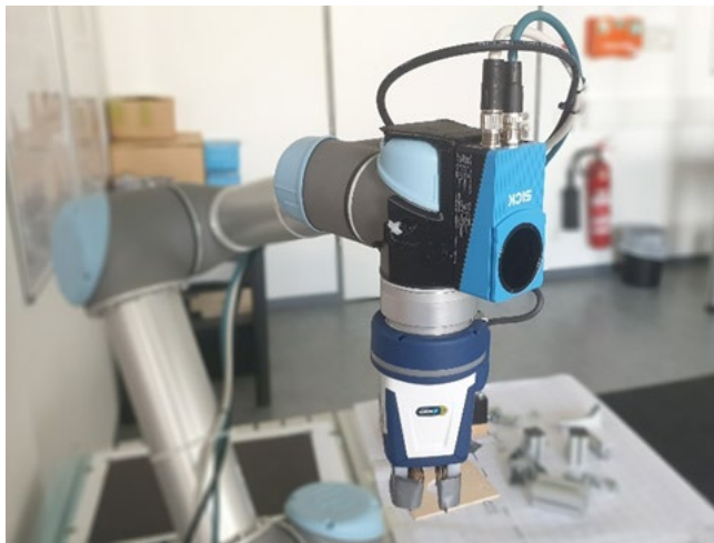
Abbildung 2: Roboter mit 3D Kamera zur Objekterkennung
