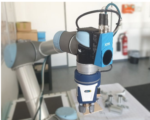
Abbildung 2: Roboter mit 3D Kamera zur Objekterkennung
