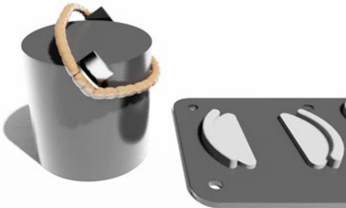
Abbildung 2: Simulation eines O-Rings, modelliert aus mehreren Starrkörpern, welche durch Gelenke miteinander verbunden sind.
