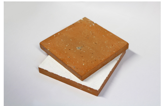
Abb. 1: Mit der Applikation neuentwickelter Nanofasern aus Polystyrol in einer Ziegelplatte gelingt die Absenkung der Wärmeleitfähigkeit von \lambda_{10, \tau} = 0,362 \text{ W/mK} auf \lambda_{10, \tau} = 0,178 \text{ W/mK} und damit eine Verdoppelung der Wärmedämmwirkung
