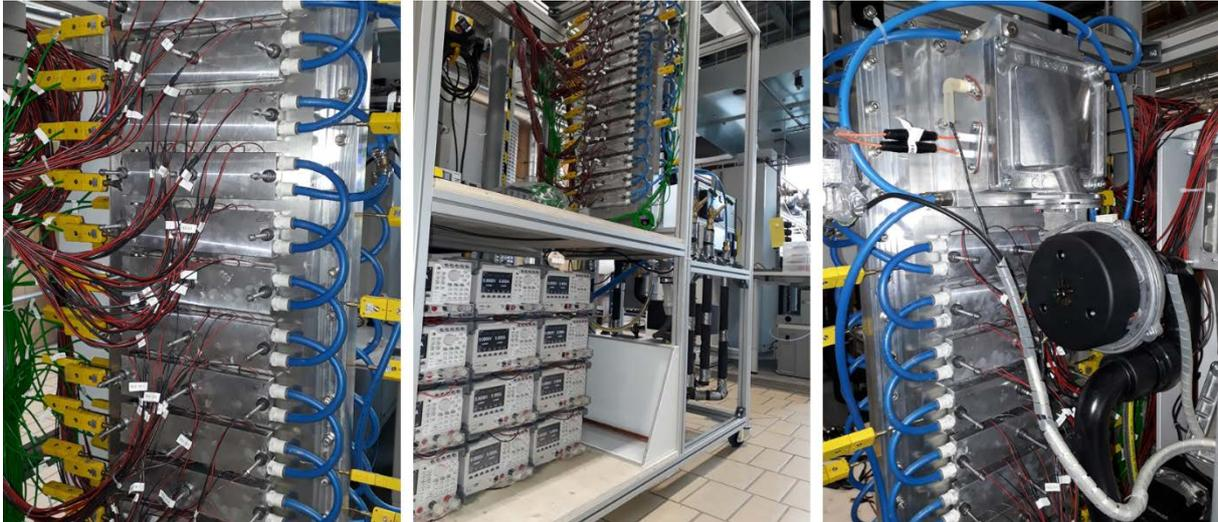
Abbildung 9: Kühler mit Thermoelementen und Verkabelung der TEG (links), elektronische Lasten mit darüber liegendem Wärmeübertrager (Mitte), Brenner mit Gebläse (rechts)
