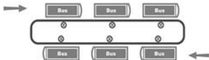
Bild 26: Mittelbussteg mit innen liegender Aufenthalts- und Wartefläche
