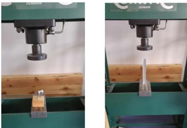
Abbildung 4: Aluminium Probekörper eingespannt in der hydraulischen Presse
