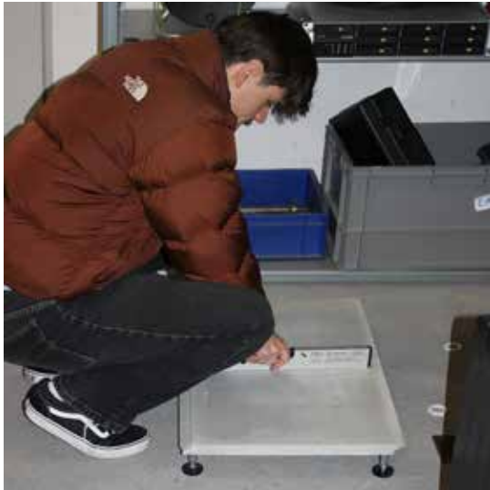
Abb. 63 Untersuchungen für biegeweiche Vorsatzschale Lösungsstrategie II – Prüfung der waagrechten Plattenlage (MoPa)
