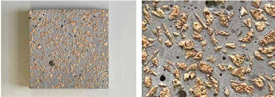
Abb. 88 Corkcrete: CEM II/B-M, 10% Pigment, 4-8 mm Granulat. Plattenmuster 10 x 10 cm (links); Detailaufnahme (rechts) (Meyerhöfer, Februar 2025) (Ohm-AR)
