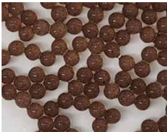
Abb. 37 Lignin–Alginate-Hydrogelpartikel direkt nach der Gelierung (Hybrid-Ansatz). (TUHH-TVT)
