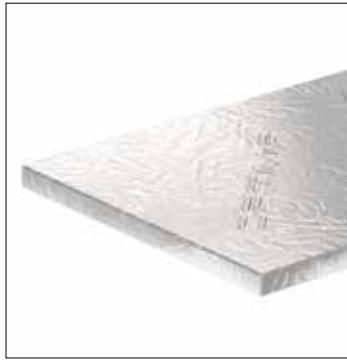
Abb. 52 ViP Optim-R Wärmeleitfähigkeit: \lambda = 0,007 \text{ W/mK} (Kingspan)
