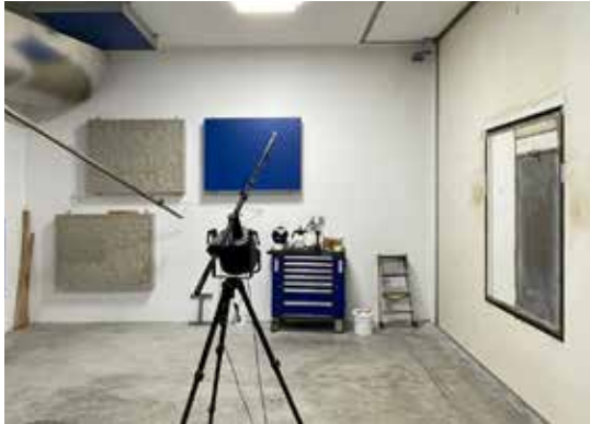
Abb. 59 Rosenheim, Prüfstand Senderaum, Messung Luftschalldämmung am Funktionsmodell I, 06.11.2024 (OHM-AR)
