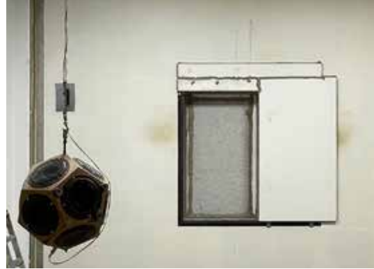
Abb. 60 Rosenheim, Prüfstand Empfängerraum, Messung Luftschalldämmung am Funktionsmodell I, 06.11.2024 (OHM-AR)
