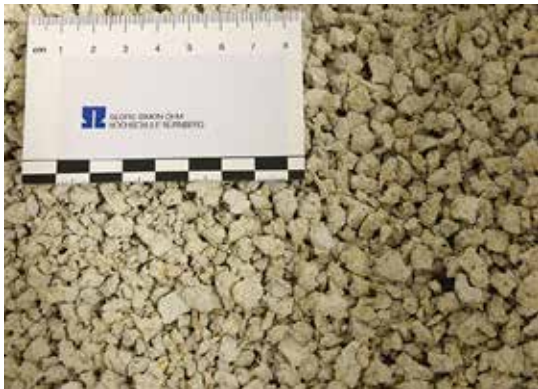
Abb. 9 Rezyklierung von Holzleichtbeton (rHLB) (Foto: Thomas Freimann)
