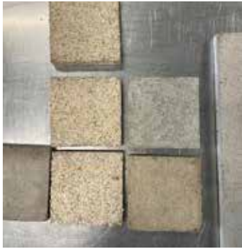
Abb. 34 Holzleichtbeton (HLB) – Plattenmuster (OHM-AR)
