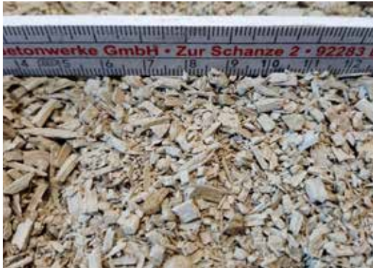
Abb. 32 Betonlabor – Zuschlagstoff: CEM-WOOD (Meier)
