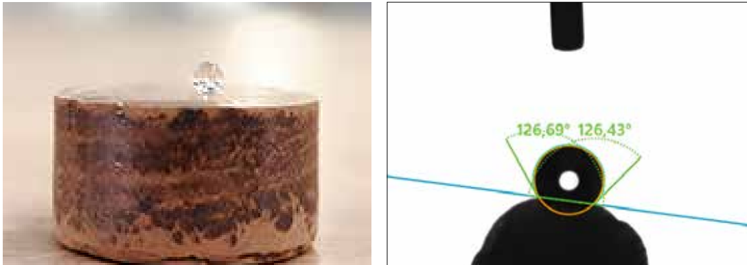
Abb. 45 Kontaktwinkelmessung auf gepressten Lignintabletten nach C4F8-Plasmabehandlung. (TUHH-TVt)
