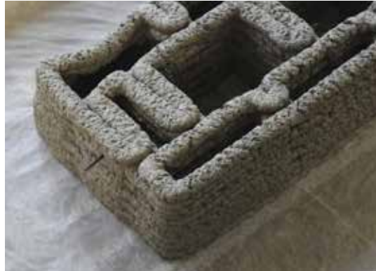
Abb. 6 Außenwandelement durch Extrusion von HLB hergestellt (Foto: TU München, Lehrstuhl Holzbau und Baukonstruktion)
