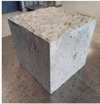
Abb. 35 HLB – Probewürfel / Holz hackschnitzel (Meier)
