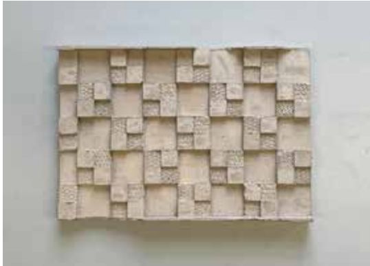
Abb. 89 Plattenmuster (29,7 cm x 42,0 cm) Tonmehl (Liament ct) (GL_M2) (Krippner/Freimann, Wintersemester 2024/2025) (Ohm-AR)
