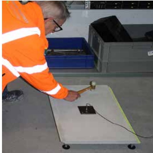
Abb. 64 Untersuchungen für biegeweiche Vorsatzschale Lösungsstrategie II – Messaufbau, Impulsanregung (MoPa)
