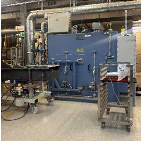
Abb. 39 64-Liter-Autoklav für überkritisches CO 2 -Trocknen. (TUHH-TVV)
