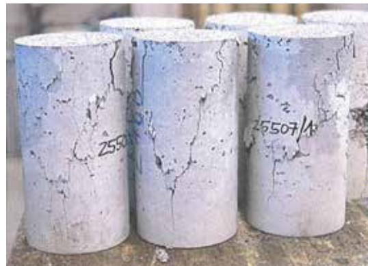
Abb. A48 Prüfkörper PK 25507/1-3 nach der Druckprüfung (IAB Weimar, 17.06.2025, S. 3)
