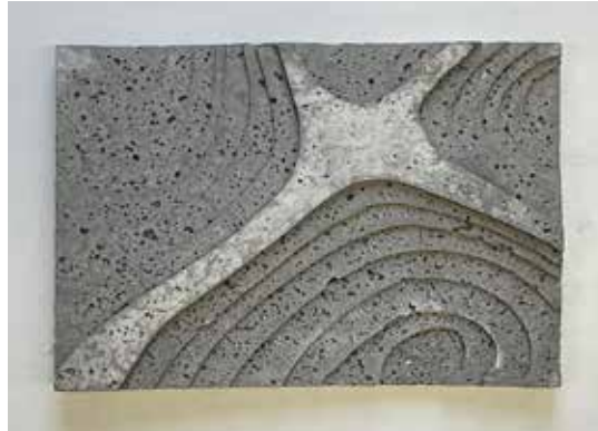
Abb. A154 Plattenmuster (29,7 cm x 42,0 cm) Holz + Pflanzenkohle (bzw. Biokohle bzw. Pyrolysekohle) (FH_M2) (Krippner /Freimann, Wintersemester 2024/2025) (Ohm-AR)
