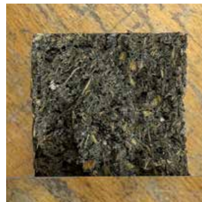
Abb. A237 Bruchfläche nach BZFP
