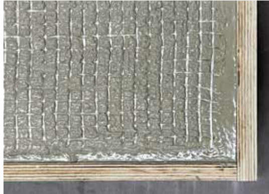
Abb. A161 2D-Gewebe AR-Glas; Zusatz Tonmehl (calc. Ton) (BKW_M4) (Ohm-AR)
