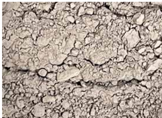
Abb. A146 Tonmehl (calciniertes Ton) (Liament ct) (Krippner/Freimann, Wintersemester 2025/2026) (Ohm-AR)
