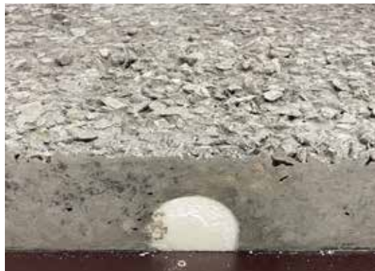
Abb. A164 Plattenmuster (45,0 cm x 70,0 cm) Korkreststoffen (BKS_M4) (links); Detailaufnahme von Plattenrückseite mit sichtbarem Korkreststoffgranulat (4-8 mm) (rechts) (Ohm-AR)
