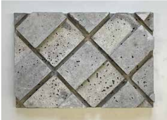
Abb. A153 Plattenmuster (29,7 cm x 42,0 cm) Holz + Pflanzenkohle (bzw. Biokohle bzw. Pyrolysekohle) (ND_M2) (Krippner /Freimann, Wintersemester 2024/2025) (Ohm-AR)
