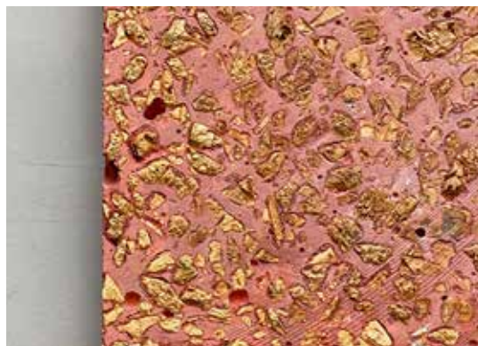
Abb. A152 Corkrete: CEM II/B-M, 10% Pigment, 8-16 mm Korkreststoffgranulat. Plattenmuster 10 x 10 cm (links); Detailaufnahme (rechts) (Meyerhöfer, Februar 2025) (Ohm-AR)
