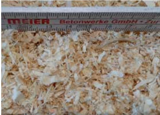
Abb. A9 Betonlabor – Zuschlagsstoff: Holzspäne / Hobelspäne (Meier)
