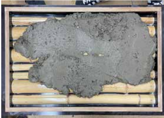
Abb. A160 Schalhaut Bambus; Zusatz Hanf (EEH_M4) (Ohm-AR)
