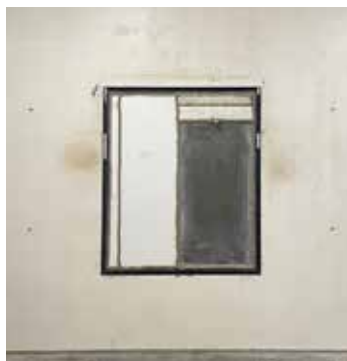
Abb. A78 Rosenheim, Prüfstand Senderaum, Messung Luftschalldämmung am Funktionsmodell I, 06.11.2024 (OHM-AR)
