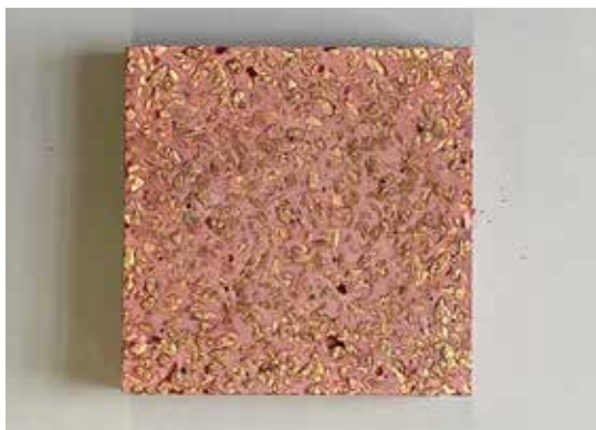
Abb. A152 Corkrete: CEM II/B-M, 10% Pigment, 8-16 mm Korkreststoffgranulat. Plattenmuster 10 x 10 cm (links); Detailaufnahme (rechts) (Meyerhöfer, Februar 2025) (Ohm-AR)
