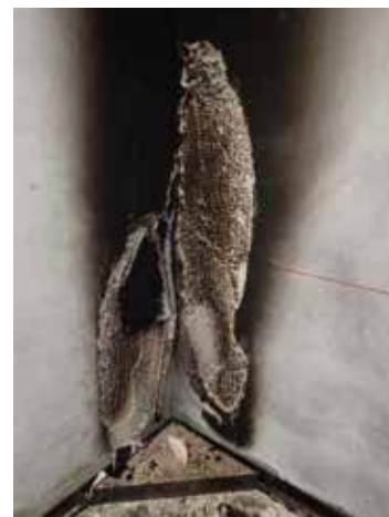
Abb. A98 Prüfkörper DZ3.1/25-141B / Ansicht nach der Brandprüfung. (MFPA Leipzig, 17. September 2025b)
