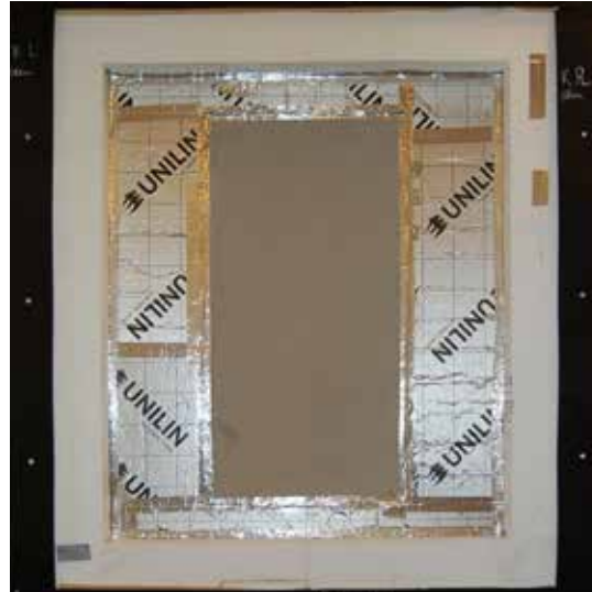
Abb. A93 Funktionsmodell mit Passepartout (180 mm PUR) in Probenrahmen eingeschäumt (Manara/Stark, 29.07.2025, S. 5)
