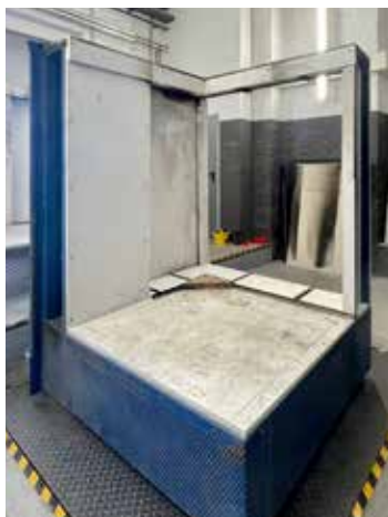
Abb. A96 Brandprüfstelle der MFPA Leipzig GmbH / Prüfungen nach dem SBI-Verfahren. (Ohm/AR)
