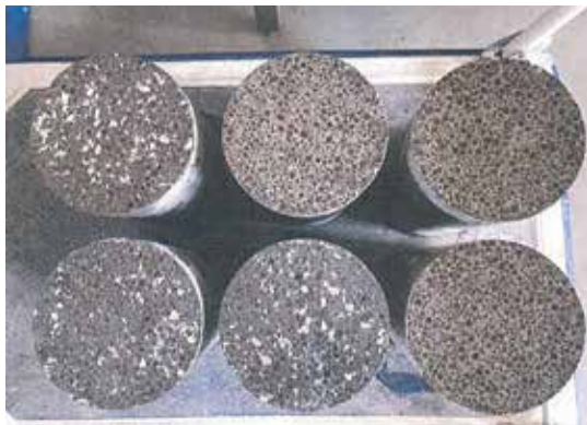
Abb. A47 Oberflächen der vorbereiteten Proben. (PK 25507/1-3) (links) (PK 25506/1-3) (rechts) (IAB Weimar, 17.06.2025, S. 2)
