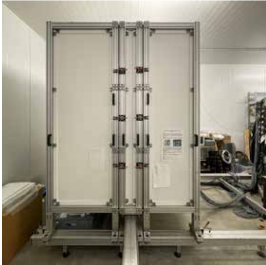
Abb. A92 Hot-Box des Center for Applied Energy Research e.V. (CAE) mit eingebautem Funktionsmodell (12.06.2025) (Ohm/AR)
