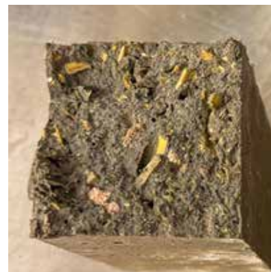
Abb. A247 Bruchfläche nach BZFP
