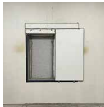
Abb. A79 Rosenheim, Prüfstand Empfängerraum, Messung Luftschalldämmung am Funktionsmodell I, 06.11.2024 (OHM-AR)
