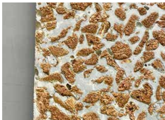
Abb. A151 Corkrete: CEM III/B, 8-16 mm Korkreststoffgranulat. Plattenmuster 10 x 10 cm (links); Detailaufnahme (rechts) (Meyerhöfer, Februar 2025) (Ohm-AR)
