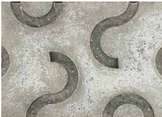
Abb. A164 Plattenmuster (45,0 cm x 70,0 cm) Korkreststoffen (BKS_M4) (links); Detailaufnahme von Plattenrückseite mit sichtbarem Korkreststoffgranulat (4-8 mm) (rechts) (Ohm-AR)
