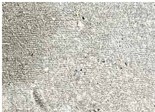
Abb. A165 Plattenmuster (45,0 cm x 70,0 cm) Tonmehl (calciniertes Ton) (Liament ct) (BKW_M4) (links); Detailaufnahme (M 1:1) von textiler Oberflächentextur (alle Krippner/Freimann, Wintersemester 2025/2026) (Ohm-AR)
