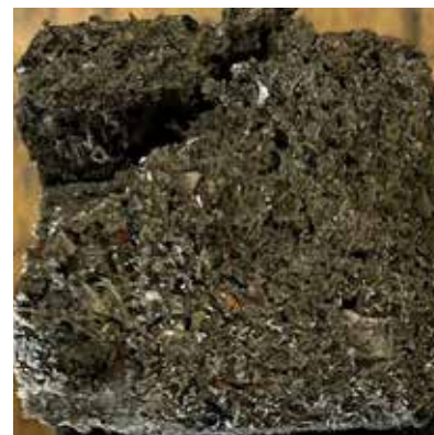
Abb. A191 Bruchfläche nach BZF
