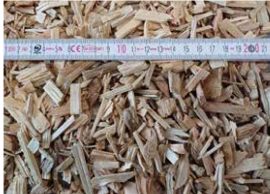
Abb. A10 Betonlabor – Zuschlagsstoff: Hackschnitzel (Meier)
