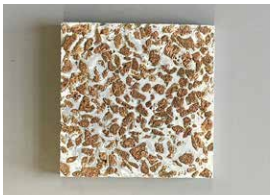
Abb. A151 Corkrete: CEM III/B, 8-16 mm Korkreststoffgranulat. Plattenmuster 10 x 10 cm (links); Detailaufnahme (rechts) (Meyerhöfer, Februar 2025) (Ohm-AR)
