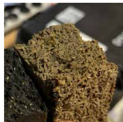
Abb. A221 Prüfprisma / Bruch
