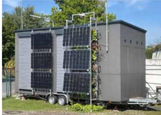
Abb. 26 Fassadenversuchsstand mit geneigten PV-Modulen (7,5 °) – System Kramer / Variante 2 (September 2023) (THN-AR)
