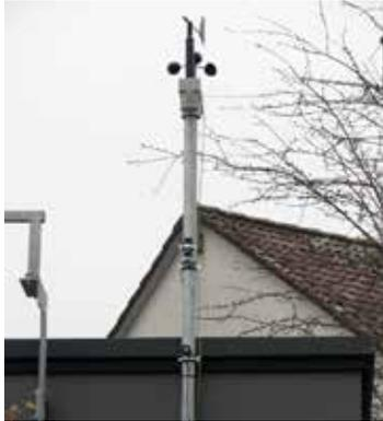
Abb. 29 Wetterstation mit den Pyranometern zur Messung der solaren Einstrahlung (THN-ieg)
