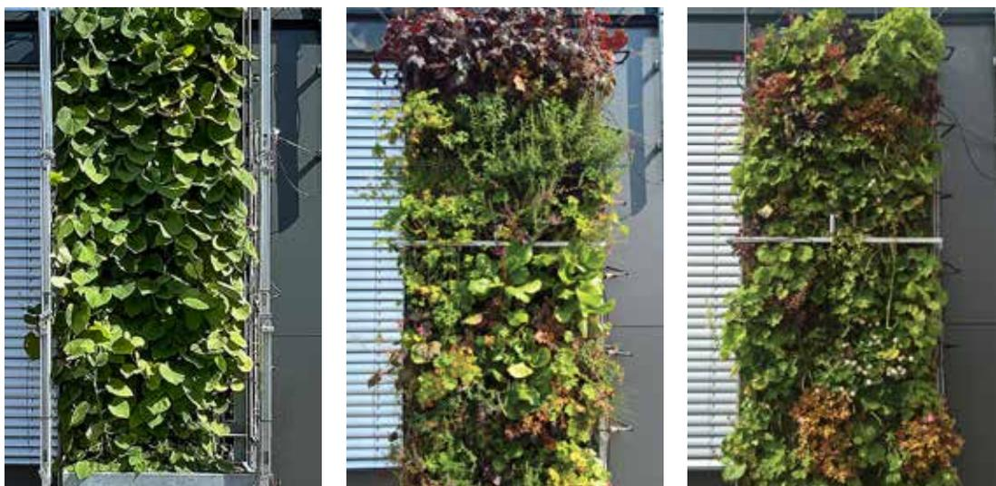
Abb. 13 Rednitzhembach, Technikum / Fassaden-Versuchsstand, Begrünungssysteme (THN-AR)
