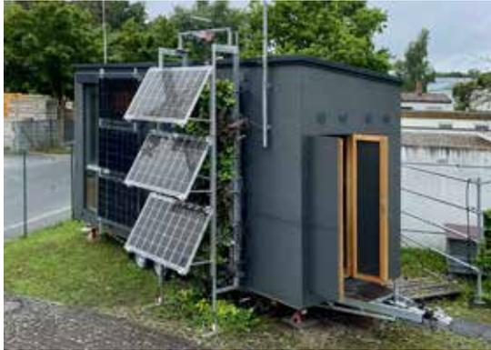
Abb. 25 Fassadenversuchsstand mit geneigten PV-Modulen (30 °) – System Kramer / Variante 2 (August 2023) (THN-AR)
