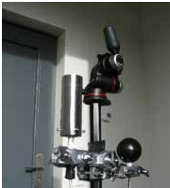
Abb. 33 Hydrothermogeber mit Strahlungsschutz zur Messung der Raumlufttemperatur sowie Globe- Thermometer (THN-ieg)
