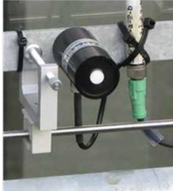
Abb. 30 Pyranometer zur Messung der solaren Einstrahlung auf die Senkrechte hinter den Begrünungssystemen (THN-ieg)
