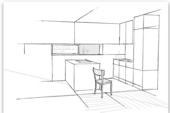
Hier ist die Küchenskizze. Im Folgenden lassen wir den Stuhl weg und identifizieren einige der notwendigen Konstruktionslinien, die für die Konstruktion der Zeichnung verwendet werden.
