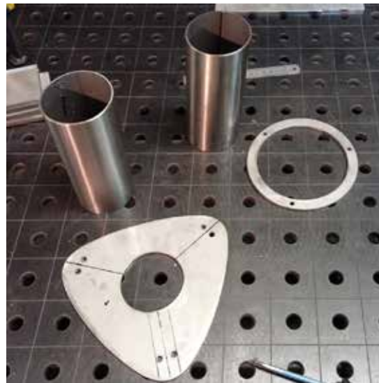
Abb. 88 Edelstahlteile Kopfplatte Variante 2 für Prototyp Rohr
