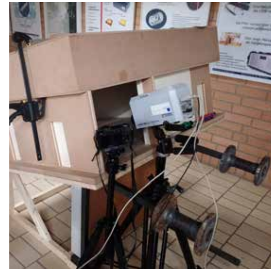
Abb. 21 Versuchsaufbau am Modell mit Leuchtdichtkamera Lumicam 1300
