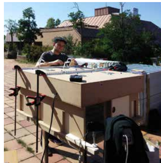
Abb. 53 Montage der opaken Sollektor-Modelle (M 1:10) als Verschatterelemente
