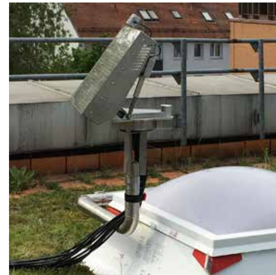
Abb. 89 Prototyp Rohr (Kopfplatte Variante 2) mit installiertem Sollektor
