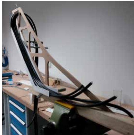
Abb. 86 Muster Seitenteil Karosserie (M 1:1) mit Test der seitlichen Kabelführung
