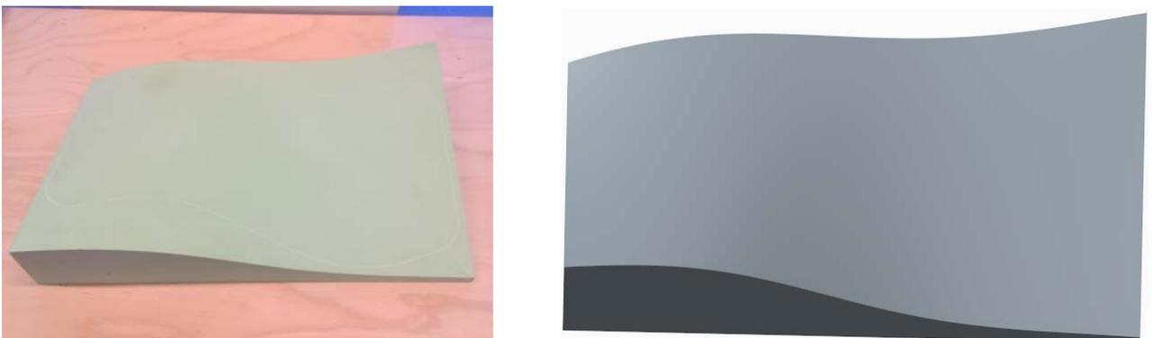
Abbildung 102. Musterbauteil ohne Mulde: links die starre Laminierform, rechts das CAD-Modell des Musterbauteils.
