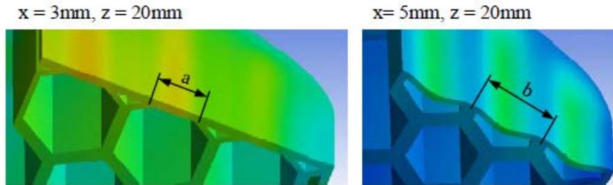
Abbildung 43. Unterschiedlich resultierende Hebelarme ( $a < b$ ) in der Wand in Abhängigkeit vom Wert  $x$ .
