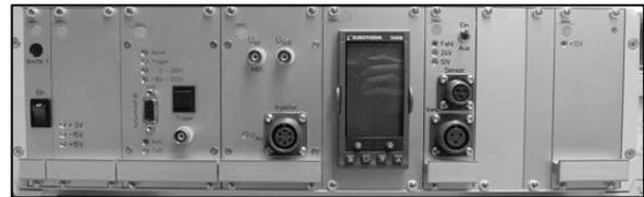
Abb.7. Elektronische Injektorsteuerung von Genotec (CR-Piezoinjektoren)
