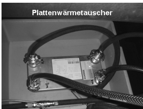
Abb.5. Plattenwärmetauscher des Kraftstoffkühlers
