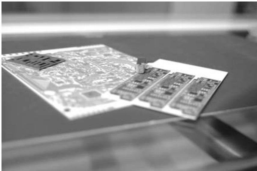
Keramische Multilayer Schaltungsträger mit verborgenen Durchkontaktierungen.
