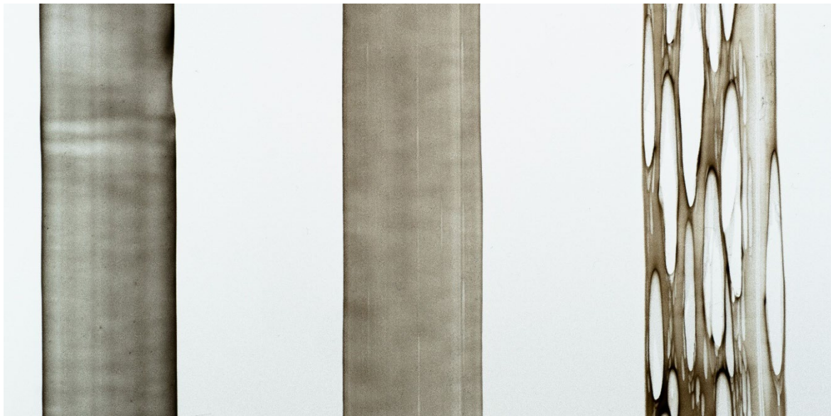
Abbildung 10: Extrudierte Bänder mit 0 % (Referenz), 1 % und 3 % PDNC (von links nach rechts) sowie jeweils 0,1 % CNTs. Bild: Florian Bauer
