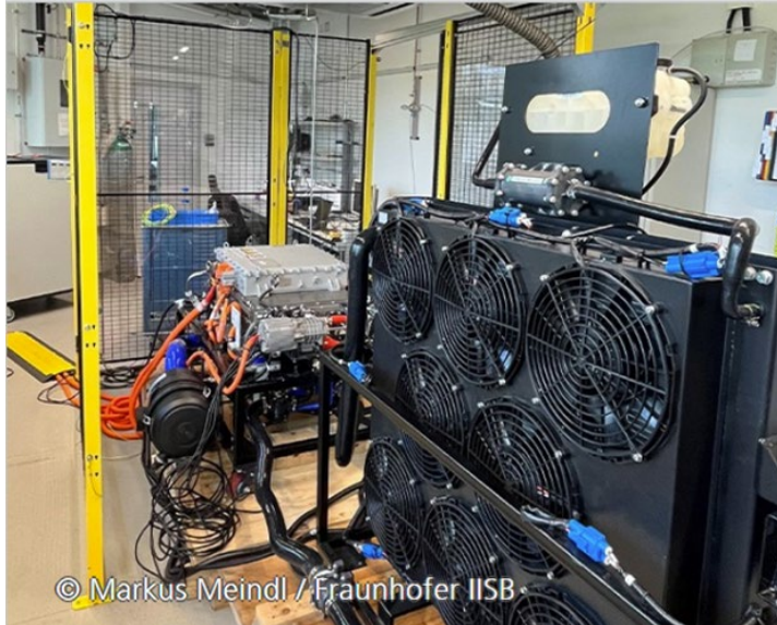
Abbildung 9: Brennstoffzellensystem des Testaufbaus. Quelle: Markus Meindl/Fraunhofer IISB
