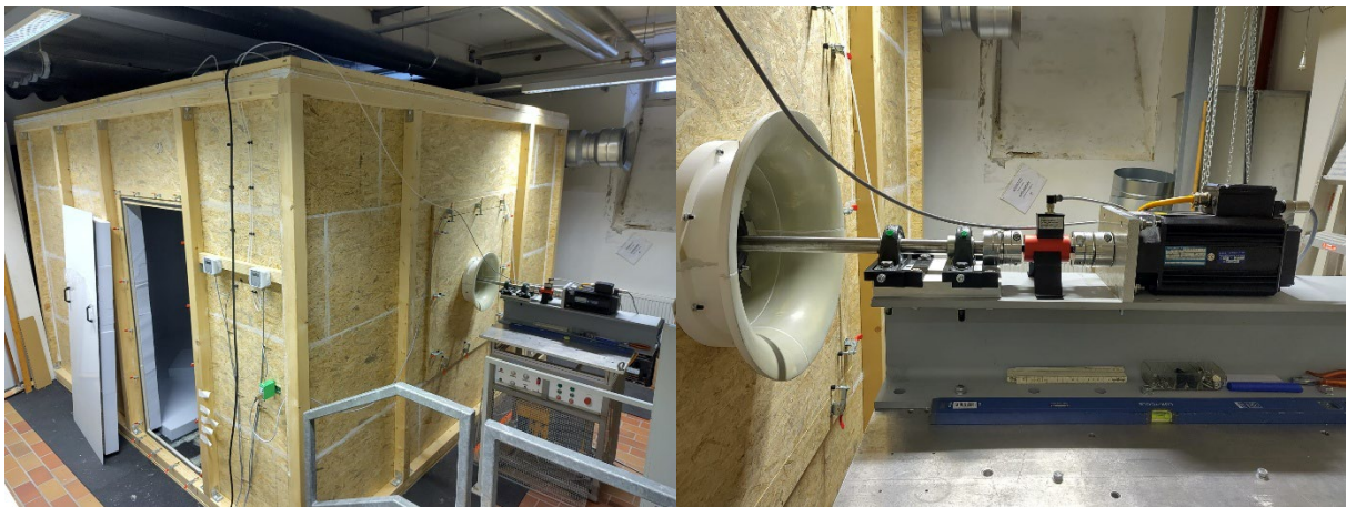
Abbildung 4: Leistungsprüfstand DIN ISO 5801 inklusive akustischer Auskleidung in fortgeschrittenem Zustand (links) sowie Darstellung des realisierten Antriebsstranges zum Betrieb einer weiten Bandbreite an Prototypen. Bilder: Till Biedermann
