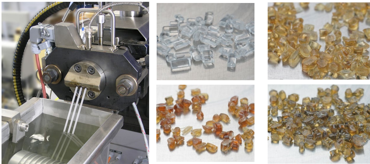
Abbildung 4: Strangextrusion von Polycarbonat (links) und hergestellte Granulate ohne CNTs (rechts). Bilder: Herbert Schlachter
