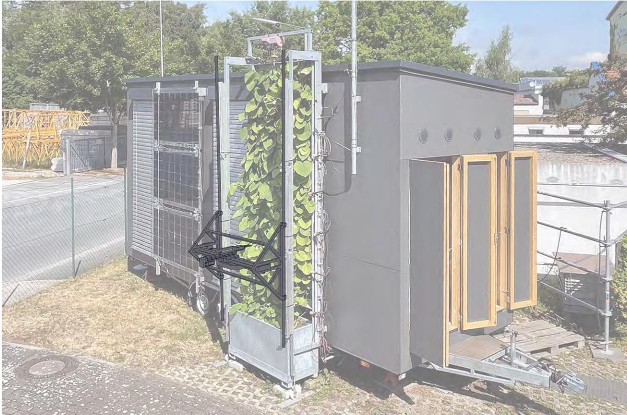
Abbildung 17: Rednitzhembach, Technikum / Fassaden-Versuchsstand. Die Variante Portalbauweise des „GreenFaCe“-Roboter als Demonstrator für Tests vor Fassadenbegrünung mit Kletterpflanze. Bild: Fakultät Architektur
