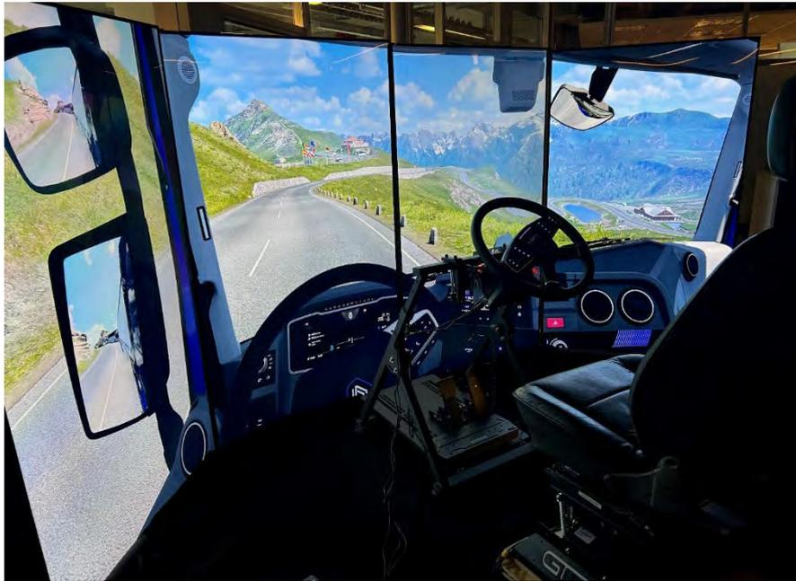
Abbildung 1: Aufgebautes Setup des Simulators mit großflächigen Displays und einem adaptierbaren Cockpit. Bild: Timo Götzelmann
