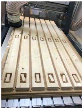
Abb. 13: Fertigung in CNC-Fräse. Bild: Benedikt Buchmüller
