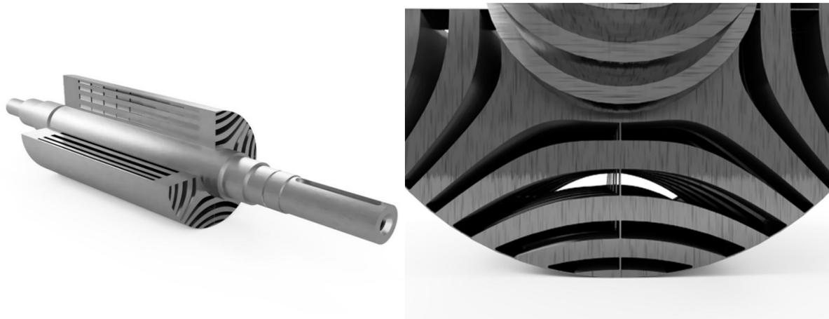
Abbildung 3: CAD-Darstellung einer V-förmigen Staffelung des Rotors einer vierpoligen SynRM. Abbildung des gesamten Rotors (links), vergrößerte Darstellung der verdrehten Flussbarrieren und Eisensegmente (rechts). Bild: Michael Schmidt
