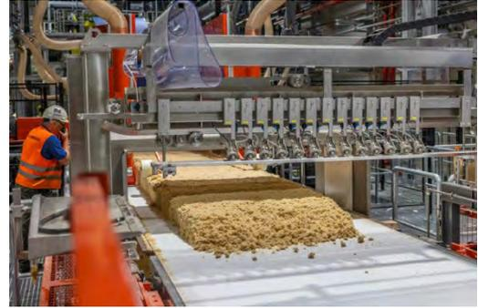
Abb. 7: Naturheld, Herstellung Holzwolledämmung.
