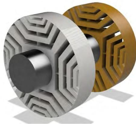
Abbildung 7: Verdrehung und Montage der Blechpakete auf der Motorwelle. Bild: Michael Schmidt
