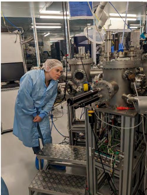
Abbildung 2: Bei der Reinraumbesichtigung des IAPP nutzten die Projektmitarbeitenden die Gelegenheit, in das Innere einer Aufdampfanlage zu blicken. Mithilfe einer solchen Apparatur werden Organische Photodetektoren hergestellt, die von den Projektmitarbeitenden synthetisierte Materialien enthalten. Bild: Markus Hummert.
