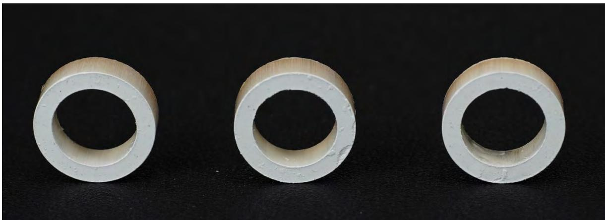
Abbildung 119: Grünkörperringe: Referenz-Binder 1 (links), Referenz-Binder 2 (mittig), Bio-Binder 1 (rechts). Bild: Florian Bauer
