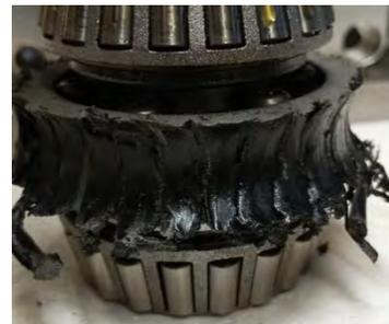
Abbildung 25: Beschädigtes Schneckenrad aus Nylon12 bei Trockenlauf, Betrieb bei  $n_1 = 500 \text{ min}^{-1}$  und  $T_{Z,max} = 24 \text{ Nm}$ . Bild: Johannes Gründer
