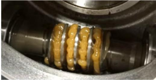
Abbildung 20: Schmierfett in einer Schneckenwelle.
