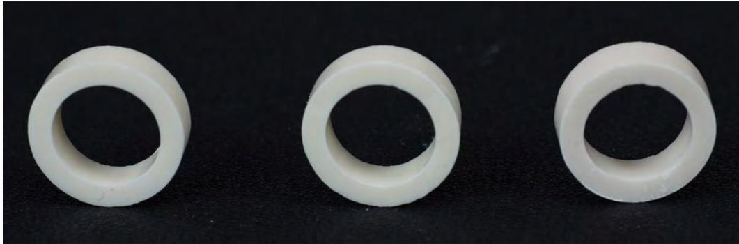
Abbildung 13: Ringe nach dem Sintern: Referenz-Binder 1 (links), Referenz-Binder 2 (mittig), Bio-Binder 1 (rechts). Bild: Florian Bauer
