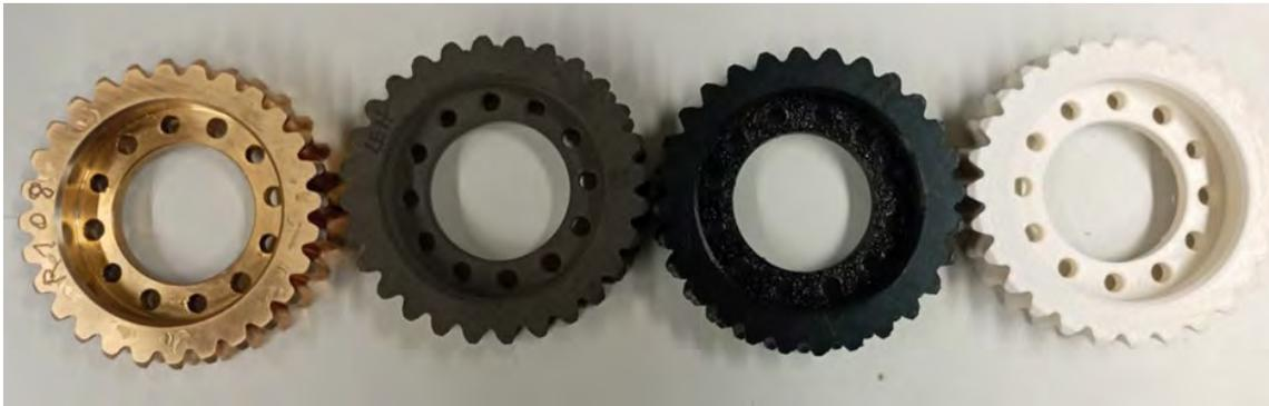
Abbildung 1: Schneckenräder aus den Materialien (von links): Bronze, Nylon12, PLA und ABS. Bild: Johannes Gründer
