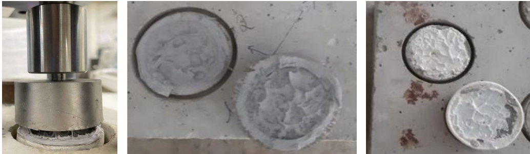
Abbildung 1: Haftzugversuch eines Bauklebesystems. Bild: Carolin Moritz, Jaqueline Mailer
