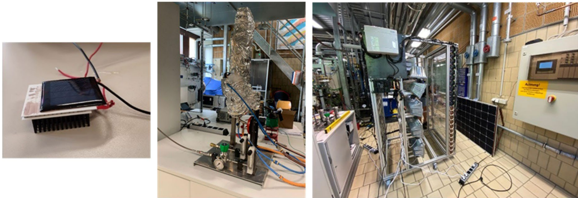
Abbildung 1: PV-Modul mit Thermoelektrikmodul (links), Wasserstoffbrenner mit Thermoelektrikmodul (Mitte), PVT-Modul mit (vorhandener) künstlicher Sonne (rechts), Bilder: Versuchsgruppen
