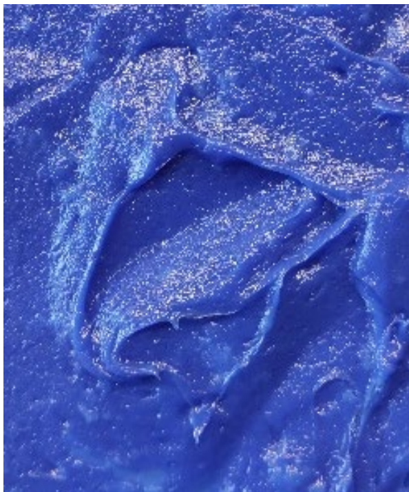
Abbildung 2: Links: hergestelltes Schmierfett blau eingefärbt; rechts: Konsistenzprüfung des Schmierfetts nach DIN ISO 2137. Bild: Steven Singer
