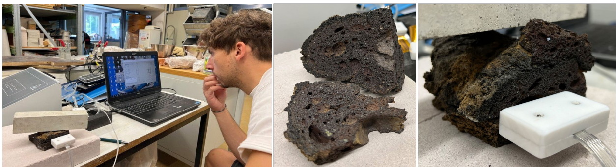
Abbildung 10: Andreas Dreker, Geographiestudent der RUB, misst im Baustofflabor der Ohm die Wärmeleitfähigkeit von Lavaprobe. Bilder: Thomas Killing, BI
